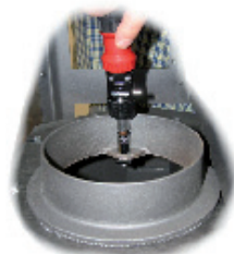
Fig. 12 Løsn boltene i røgtuden ovenud.
