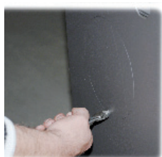
Fig. 9 Klip det lille stykke metal over, der forbinder dækslet med bagpladen med en skævbider. Vrid derefter dækslet af.
