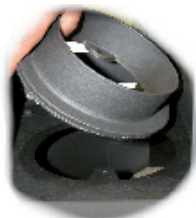
Fig. 13 Løft røgtuden ovenud af ovnen.
