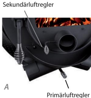
Durch das Hineinschieben des Primärluftreglers zum Ofen hin schließt die Primärluftklappe und die Verbrennungsluftzufuhr wird gedrosselt, was zu einer Erhöhung der Emissionen führen kann. Die Sekundärluftöffnungen sind aus Sicherheitsgründen nicht dicht verschließbar.
