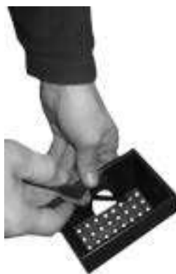
Fig. 34 - het schoonmaken van de vuurpot
