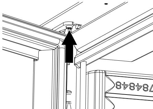
Fig. 89: Adjusting the door
