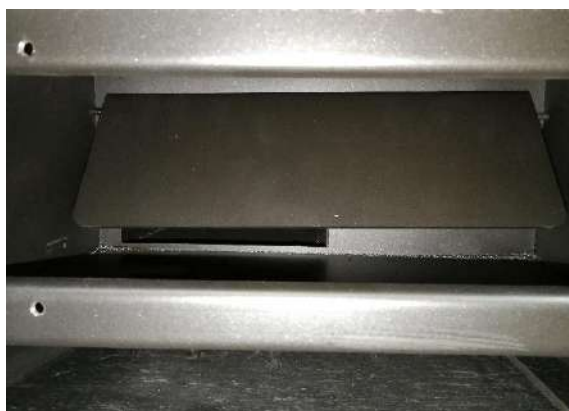
Figura 2: assicurarsi che il deflettore sia posizionato correttamente sui ganci.
