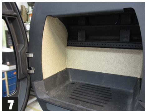
7 Linker zijplaat gemonteerd
