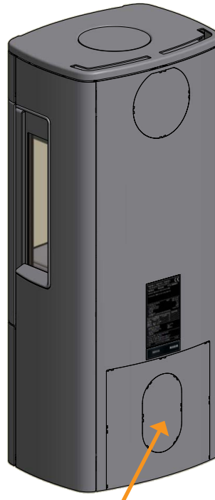
Afdekplaat moet verwijderd worden
