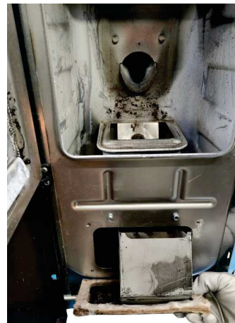
Fig. 78 - Verwijder de inspectiedop
