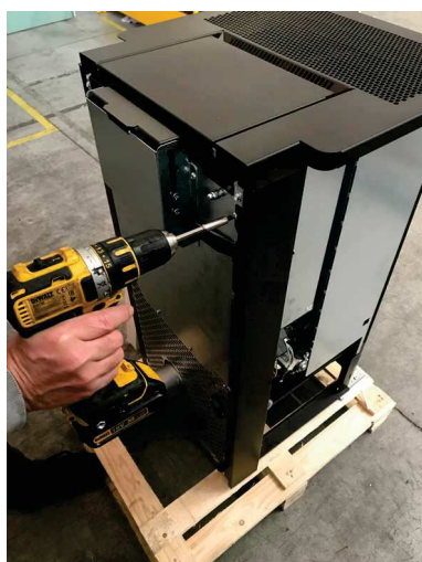
Fig. 42 - Verwijder het zwarte profiel
