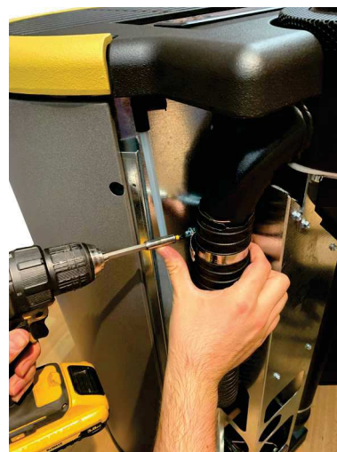
Fig. 62 - Flexibele buis naar buiten trekken
