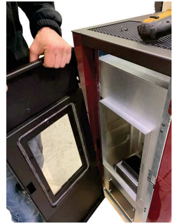
Fig. 29 - Verwijder de deur.
